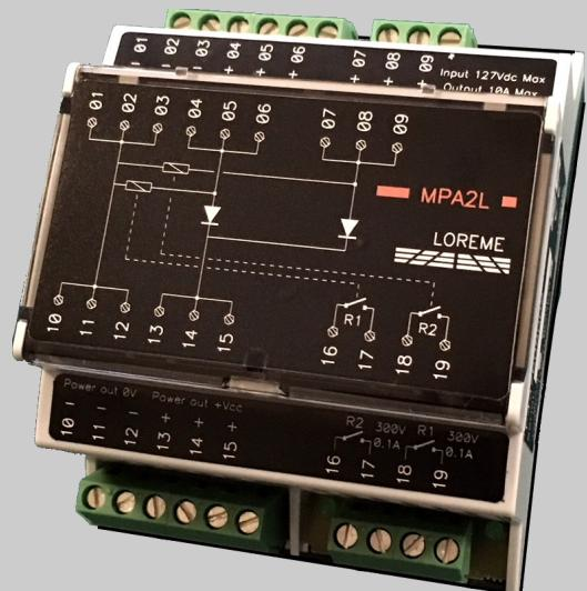
Le MPA2 permet de fournir une protection efficace contre les défaillances d'alimentations. Grâce au découplage de deux alimentations, la défaillance de l'une d'elle reste sans impact sur la sortie, l'autre prenant automatiquement sa fonction sans interruption de service.
